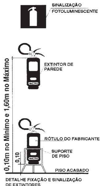
Figura 1 - Fixação de extintor
